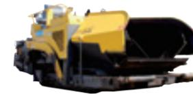
道路等のアスファルト舗装に使用。アスファルトを定められた幅と厚さに敷きならす。
