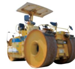
重く大きい車輪が走行することで地面に圧力をかけて押し固める。アスファルトを平坦に仕上げる。
