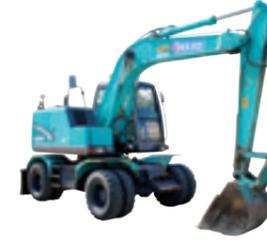
時速35kmでの移動が可能。移動が多い作業現場に最適。コンクリートやアスファルトなどの破砕作業に適している。
