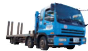
車両を安全に積み下ろしができる車両運搬車。荷台を後方にスライドさせながら傾斜させる機構と、自走できない車などの積載物を載せるため、ウインチを備えるタイプがある。
