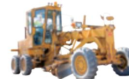
道路の路床・路盤の他、土工基面、法面の整形・仕上げ、道路補修、除雪に用いられる。
